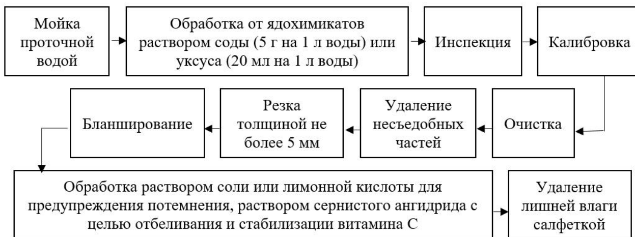
Рисунок 1 – Технологическая схема предварительной обработки сырья
