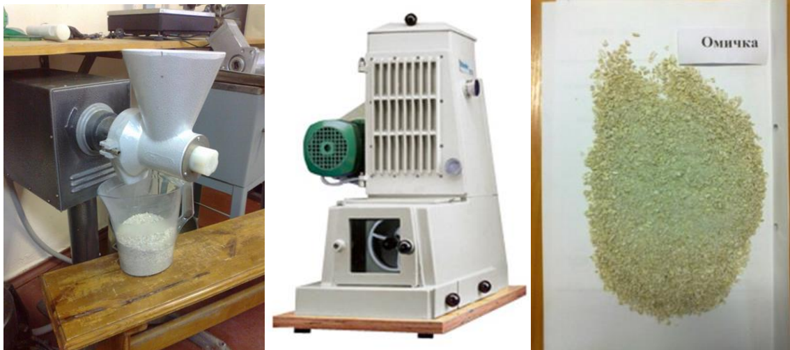
Рисунок 4 - Измельчение фасоли в крупу измельчающим механизмом (МИ) универсальной кухонной машины (УКМ) и лабораторной мельницей Квадрумат Джуниор со встроенным ситом и системой вентиляции. Частицы дробленой фасоли до измельчения.
